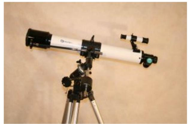
В комплекте идет экваториальная монтировка EQ1 с высококачественными мягкими тросиками тонких перемещений на устойчивой алюминиевой треноге АТЗ сечением ал профиля ног 60x25мм.
